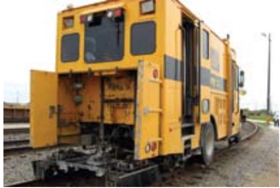
Voiture de détection des défauts de rail (triage Symington du CN), Winnipeg (Manitoba), juin 2007
