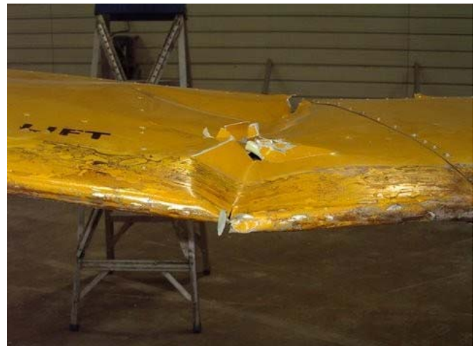
Un stabilisateur de droite endommagé
