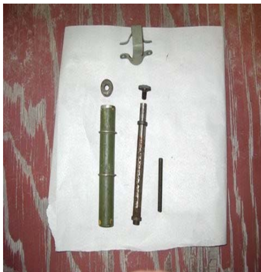
Un vérin du compensateur de profondeur droite démontée
